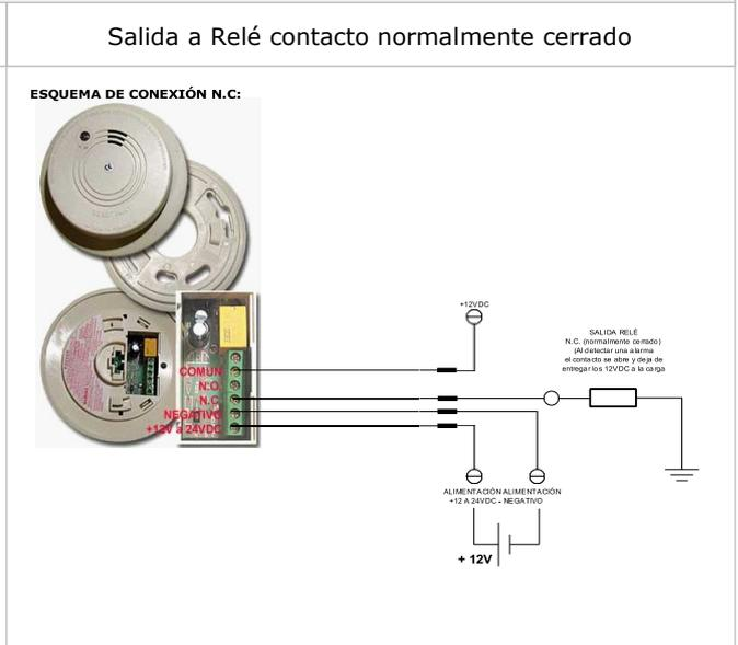
Conexiones detector de GAS GLG-965R-12220
